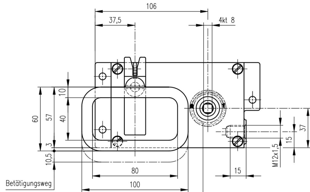
Kennzeichnung der Rückstellungseinrichtung nach UIC 545, Anlage 4, Abb. 1
